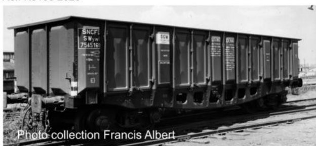
K3133 tombereau ARBEL court 4 portes panneaux emboutis ventre de poisson Nord/SNCF ép 2 à 3 Ref. K3133 2026
