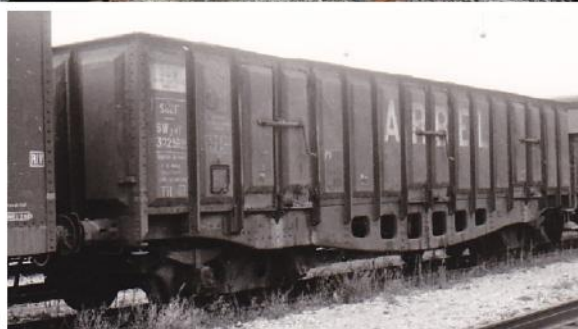
K3132 tombereau ARBEL panneaux emboutis ventre de poisson Nord/SNCF ép 2 à 4 Ref. K3133 2026
